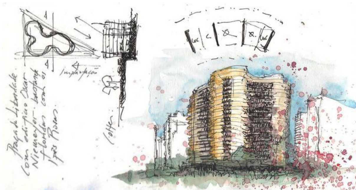
Figura 14 Edifício Niemeyer, Belo Horizonte, Minas Gerais, 1954, projeto de Oscar Niemeyer (1907-2012): o arquiteto concebe um edifício curvilíneo a partir de uma malha de pilares quase modular. Bico de pena e aquarela sobre papel Desenho: André Lissonger, s.d.
